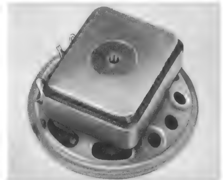
Bild 1. Kleinstlautsprecher LP 45 mit Ferritmagnet der Standard Elektrik Lorenz AG in natürlicher Größe
